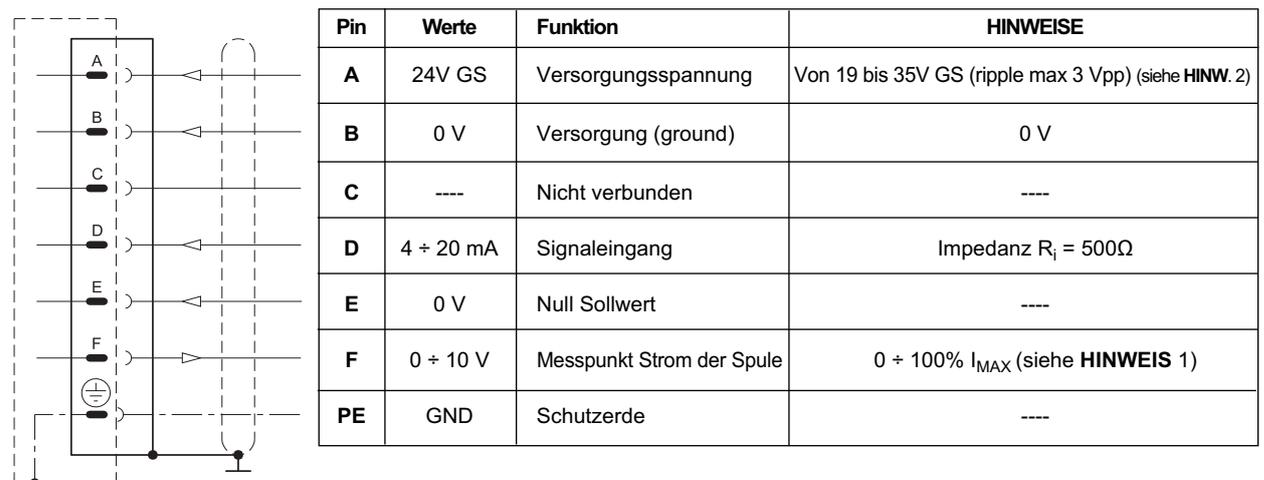
**HINWEIS für die Verkabelung:** die Verkabelung erfolgt durch das Bestücken des Verstaerkers mit dem Verbinder 7. Der Durchschnitt des Versorgungskabels muss 0,75 mm<sup>2</sup> für Kabel bis 20 Meter sein, waehrend für Kabel bis 40 Meter soll der Durchschnitt 1,00 mm<sup>2</sup> sein. Der Durchschnitt des Signalkabels soll 0,50 mm<sup>2</sup> sein. Benutzen Sie 7-Draht Abschirmkabel. Um besser sich zu schützen, benutzen Sie Kabel mit Einzelabschirmung der Drahten.
